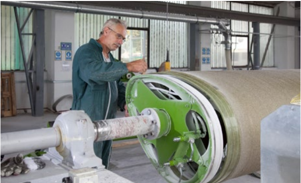
Mise en œuvre de l'extrémité du tuyau à raccorder
