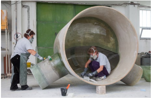
Préfabrication d'un regard pour les eaux usées
