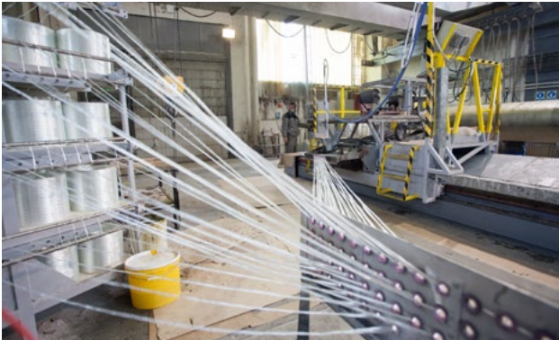
Bobinage de fibre verre continue
