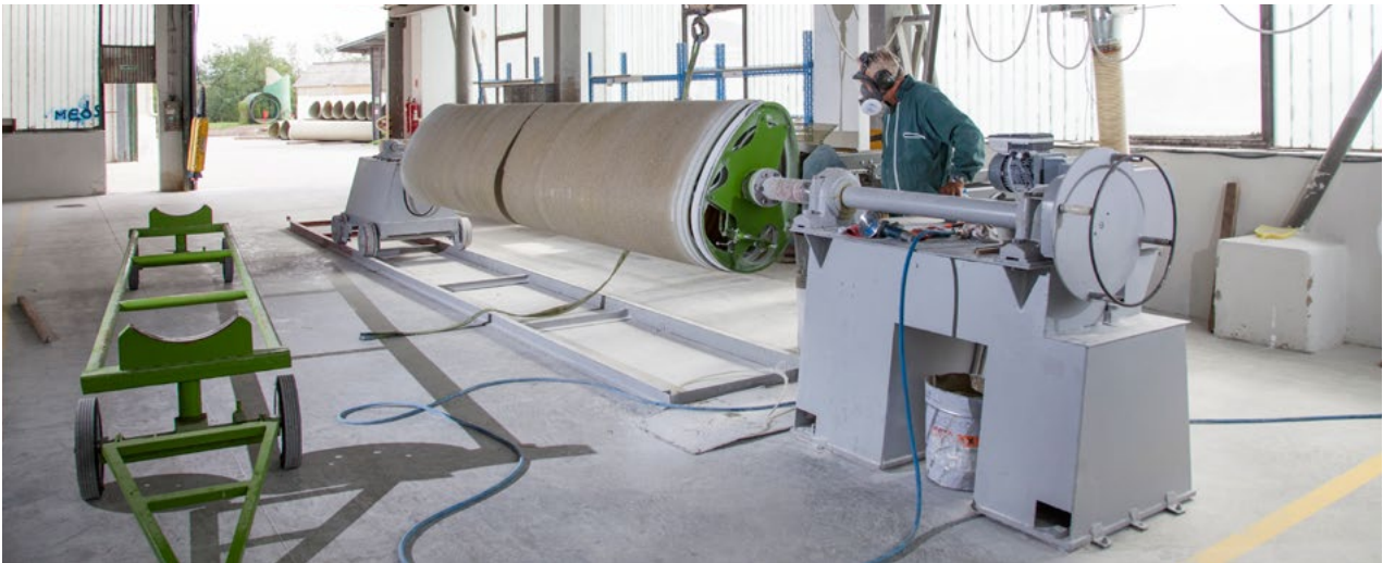
Coupe du profil à la dimension déterminée et ponçage de finition
