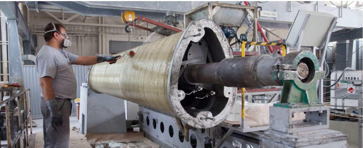
Fabrication d'un tuyau d'égout à section ovoïde
